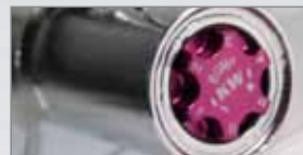
Druckstufenverstellung durch im Boden integriertes Einstellrad* / Compression damping adjustment by integrated adjustment wheel*
