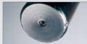
Eingelassene Druckstufenverstellung durch Innensechskant / Compression damping adjustment by allen key
